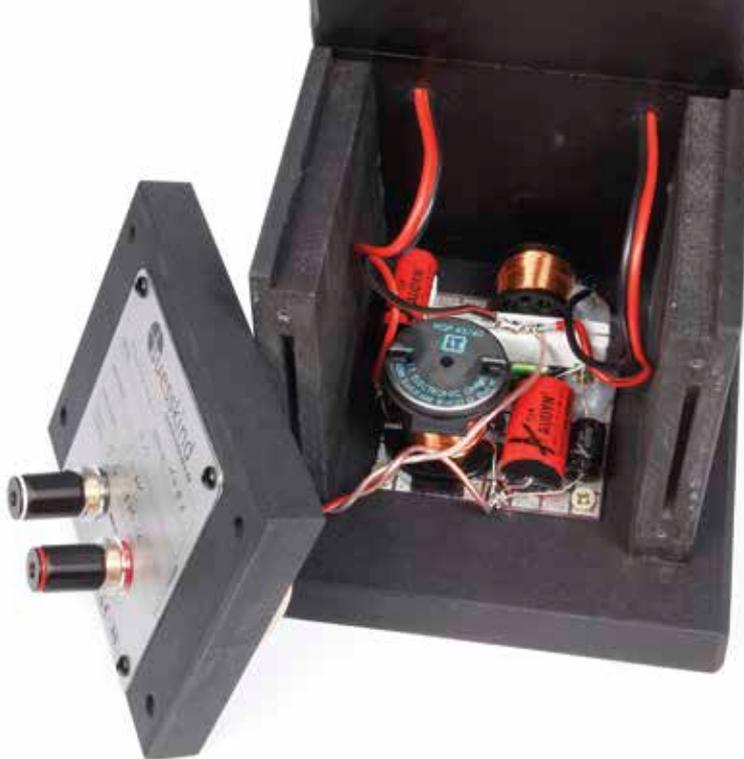
Die Frequenzweiche ist in einer separaten Kammer hinter dem eigentlichen Gehäuse untergebracht, was sie vor Vibrationen schützt; Single-Wire-Terminal.
